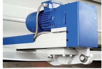
1000 mm.den uzun sacların rahat kesimi için otomatik kalkabilen arka dayama sistemi
